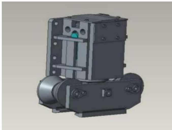
抬升滑梯小车：内部支撑缸，实现 260mm 的顶升行程。 同时抬升机架，将自移机尾抬离巷道地面；同时收回，将轨道抬离巷道地面；
